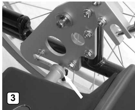
**Nota 1:** La parte elevadora deberá estar lo más centrada posible entre las ruedas de la silla de forma que sus ruedas de soporte no toquen el suelo (en modo "peldaño a peldaño" la parte elevadora recupera la posición automáticamente, véase 4.1.3)
