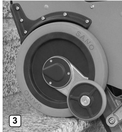
6. La pieza elevadora se despliega hasta llegar al siguiente escalón inferior. En cuanto las ruedas de soporte se posan, el Liftkar se eleva un poco (dependiendo de la altura del escalón), se desplaza un poco hacia adelante, deja bajar el aparato despacio y de forma controlada y finalmente se para en la posición neutra gracias al sistema “peldaño a peldaño”.
